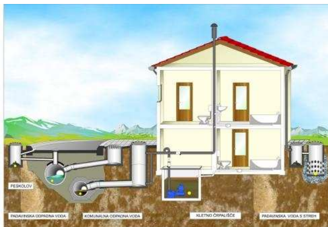
Slika: Primer ureditve odvajanja odpadnih voda iz objekta
